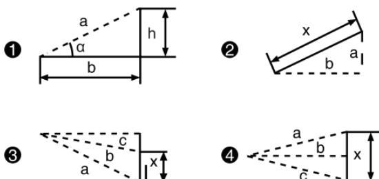
a) Расчет длин катетов через измерение гипотенузы и угла.
