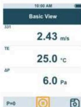
В зависимости от подсоединеного зонда можно настраивать параметры для измерения, например, отображение отдельных значений или единиц измерения.
