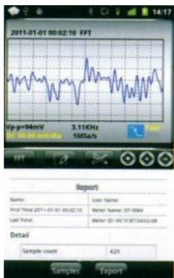
В режиме Report (Отчет) выводится подробная статистическая информация об измеренных данных, в том числе Sample count (Номер измерения), Time range (Интервал времени), Sample Freq. (Частота), Min/Max (Мин/Макс), Mean (Среднее) и т.д.
