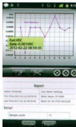
Если размер графика превышает размер экрана, данные «скимаются», чтобы весь график поместился на экране смартфона.
