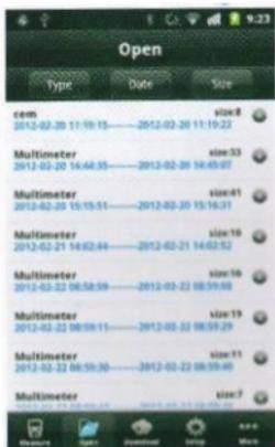
b. Для проверки файла данных «облачного» сервера, полученных в локальном режиме измерений, можно войти в режим Meterbox Download (Загрузка)
