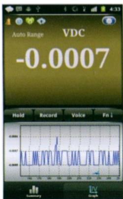
После нажатия кнопки
