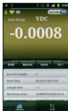
При выполнении записи можно включить режим ограниченного меню или расширенного меню (нажатием кнопки Fn↓), чтобы контролировать режимы измерений прибора.
