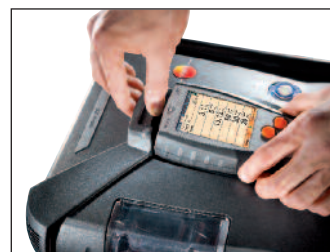
Управляющий модуль просто “защелкивается” в блок анализатора
